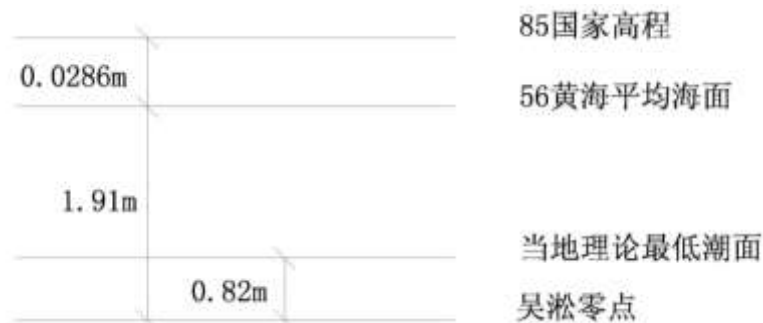
图 5.2-10 当地各基准面换算关系图
